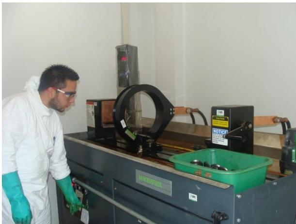
Para la magnetización se puede utilizar un banco estacionario, un yugo electromagnético, electrodos o un equipo portátil de bobina flexible, entre otros. Se utilizan los diferentes tipos de corrientes (alterna, directa, semi-rectificada, etc.), según las necesidades de cada inspección. El uso de imanes permanentes ha ido desapareciendo, ya que en éstos no es posible controlar la fuerza del campo y son muy difíciles de manipular.
